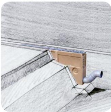
aansluiting door middel van een zandvanger
